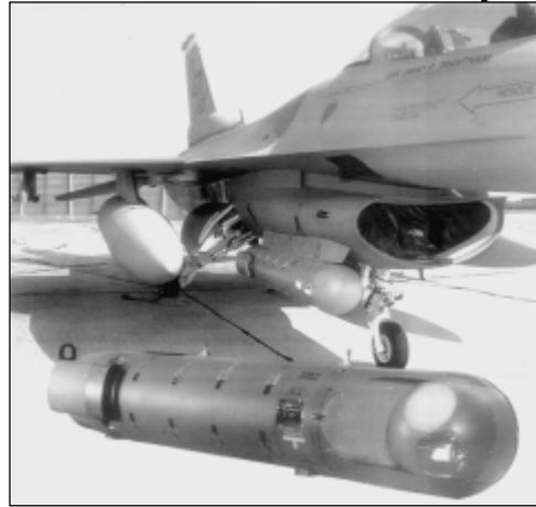
Рис. 3. Внешний вид и вариант размещения контейнера прицельно-навигационной системы «Лайтенинг-2» на тактическом истребителе F-16
